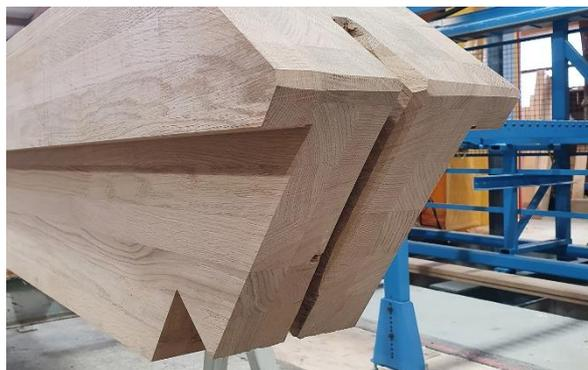
Träger aus Fagus Stabschichtholz Eiche nach erfolgtem Abbund. (Bild: Fagus Suisse)
